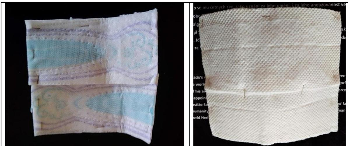
**Figura 3. Giunzione delle 2 metà tagliate e sagomate. Si consiglia una sovrapposizione di almeno 1-cm fra le parti. a) parte idrofoba interna b) parte idrofila esterna.**
