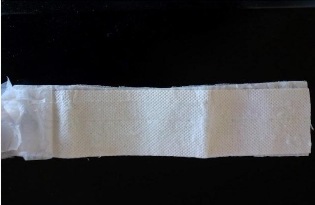
Figura 2. Campione sagomato dopo l'eliminazione della parte impermeabile adesiva idrofoba.
